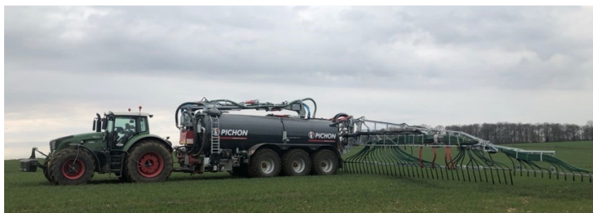
Figure 2 : Exemple de dispositif d'application de l'engrais liquide avec pendillards
